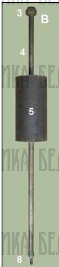
Фото 3.11. Инструменты для рихтовки металла: А - рихтовочные молотки и наковальни, 1,2,3 - рихтовочные молотки, 4,5,6,7 - наковальни, В - «фирменный» (для споттера) обратный молоток, В - самодельный обратный молоток. 1 - стержень для подключения к споттеру, 2 - рукоять, 3 - упор, 4 - стержень, 5 - боёк, 6 - пружина, 7 - контргайка, 8 - резьба для крепления насадок.
